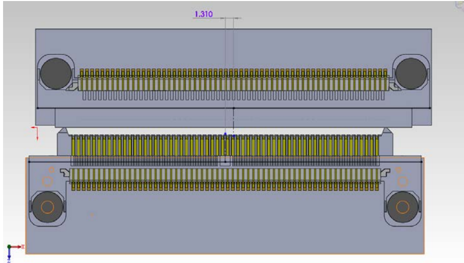
allowed misalignment in transverse axes 在橫向方向允許對插偏差量
